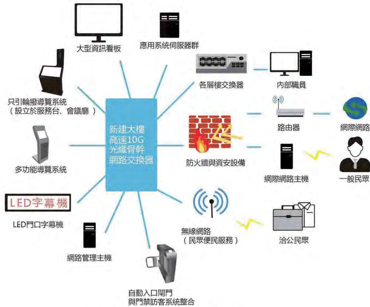
圖 2 總合佈線架構概念說明示意圖
